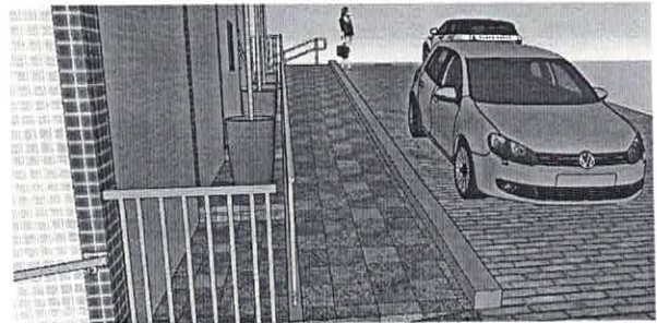
EXECUÇÃO DE PASSEIO C/1,20 NO NÍVEL DA RUA MALVINA PATRÍCIO EXECUÇÃO DE CALÇADA EM DEGRAUS C/1,20 NO NÍVEL EXISTENTE INSTALAÇÃO DE GRADE PARA SEPARAÇÃO DE AMBAS
